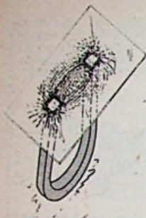
Verloop van krachtlijnen aangetoond door ijzervijlsel
